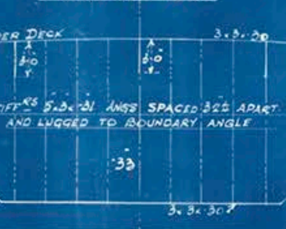
NON WT BULKHEAD - FRAME NO 62
