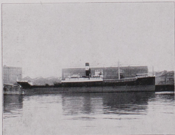
Die „Duburg“ vor der Verlängerung. Zwischen Schornstein u. Kommandobrücke soll das Verlängerungsstück eingebaut werden.
